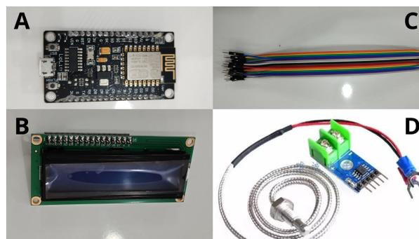
**Figura 1-** A) nodeMCU B) display LCD C) jumpers D) sensor de temperatura MAX6675
