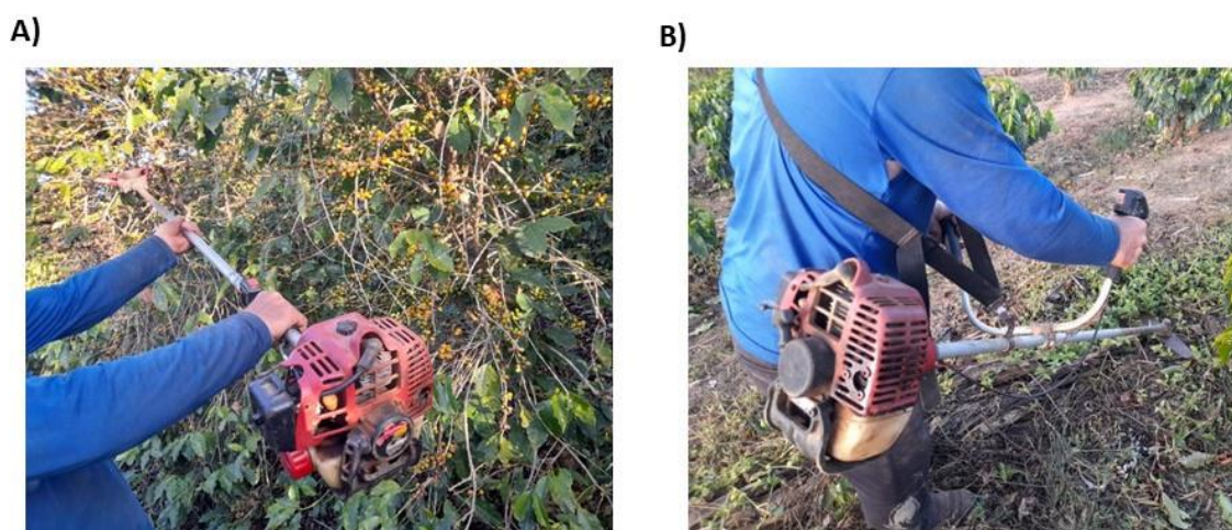
Figura 1: Equipamento multifuncional com motor Shindaiwa ® acoplado aos implementos derriçadora Brudem ® (A) e roçadora C-230 ® (B).
