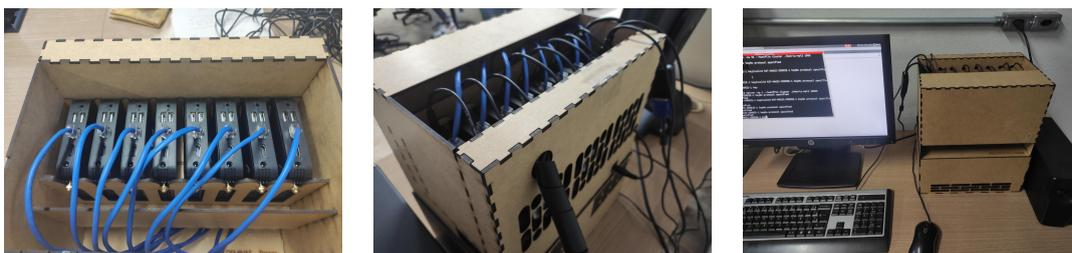
**Figura 1** – (a) Encaixe tipo gaveta vertical; (b) Fixação de *coolers*; (c) Centro com *switch* e base com filtro e fontes
