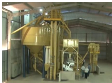
Figura 1 - As figuras A e B se referem a dois ângulos do conjunto: Selecionador eletrônico, classificador de grãos, Classificador Porto e Catador de pedras. Fonte: Elaborado pelo autor (2024).
