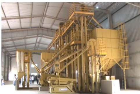
Figura 1 - As figuras A e B se referem a dois ângulos do conjunto: Selecionador eletrônico, classificador de grãos, Classificador Porto e Catador de pedras. Fonte: Elaborado pelo autor (2024).
