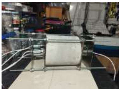
Figura 1: Forno com instalação elétrica completa
