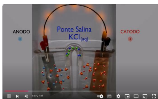
Figura 1: Funcionamento da pilha de Daniell.
