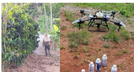
Figura 1: a) Aplicação com pulverizador costal; b) Drone pulverizador.
